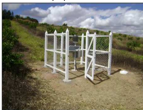
Estação pluviométrica
